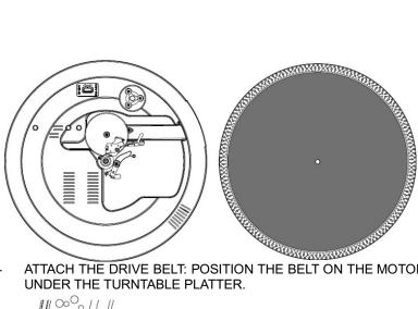
ATTACH THE DRIVE BELT: POSITION THE BELT ON THE MOTOR PULLY, THE DRIVE BELT IS TIGHTENED UNDER THE TURNTABLE PLATTER.
